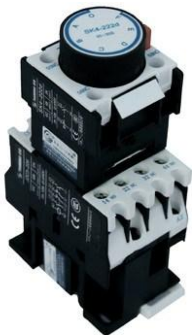
Рисунок 3.3- Крепление приставки ПВЛ на магнитный пускатель ПМЛ
