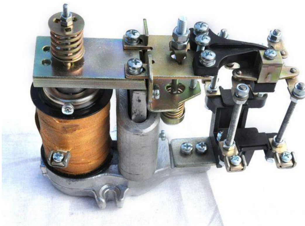
Рисунок 1.1- Реле времени с электромагнитным замедлением
