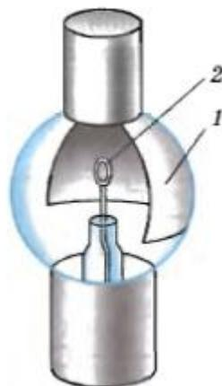
Полупроводниковый диод имеет следующее устройство—в плоском кристалле кремния или другого полупроводника с дырочной проводимостью создаётся тонкий слой полупроводника с электронной проводимостью. На границе раздела этих слоёв возникает p-n переход.
