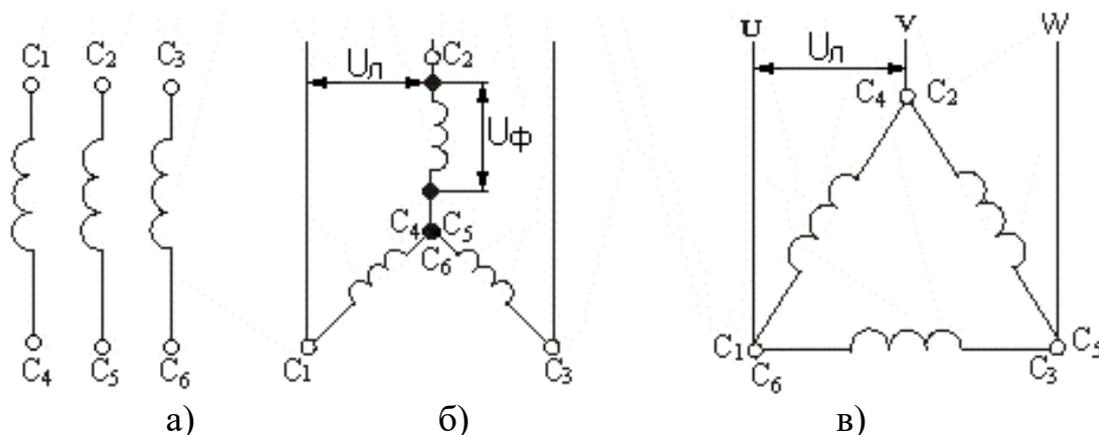
**Рисунок 1.2 - Схемы соединения статорных обмоток АД**
