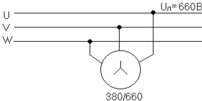
Рисунок 1.6 - Схема подключения АД при напряжении сети 660В
