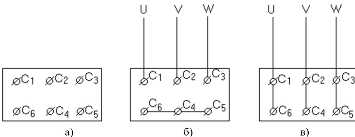
Рисунок 1.3. - Схемы подключения статорных обмоток
