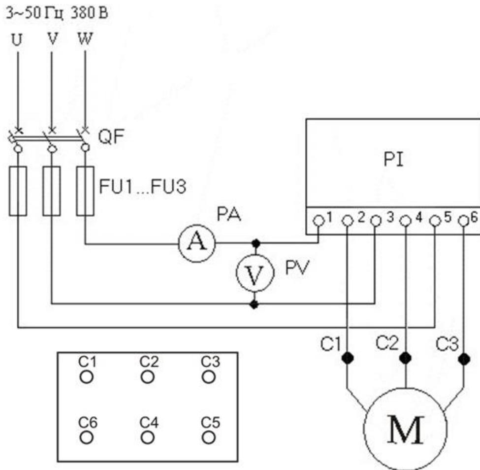
Рисунок 4.2 - Электрическая схема экспериментального определения  $\cos \varphi$
