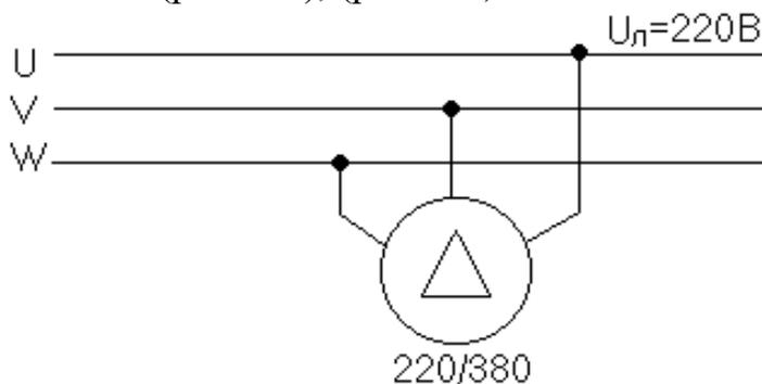
Рисунок 1.4 - Схема подключения АД при напряжении сети 220В
