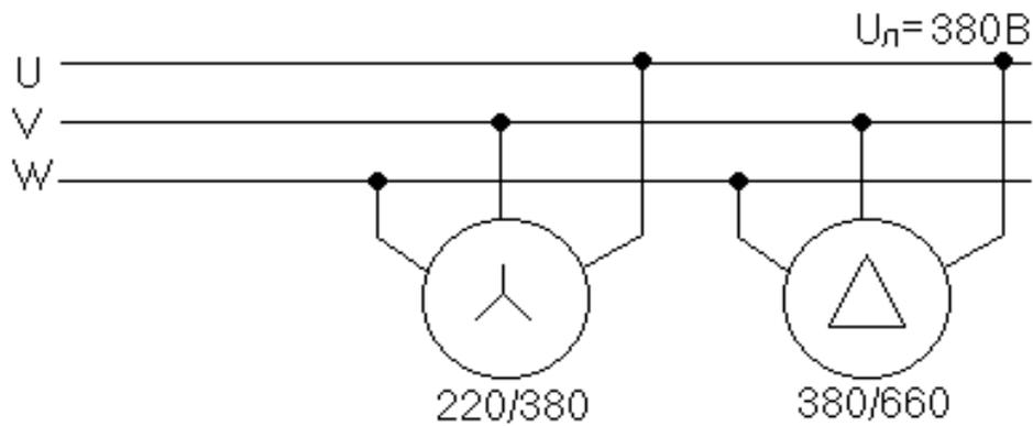
Рисунок 1.5 - Схемы подключения АД при напряжении сети 380В
