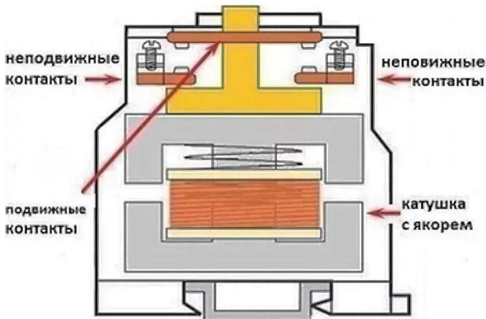
Рисунок 2.2 – Устройство магнитного пускателя
