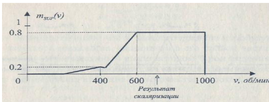
Рисунок 37 - Получение скалярного значения скорости вращения вентилятора методом «центра тяжести» для температуры t = 28\text{ }^{\circ}\text{C}
