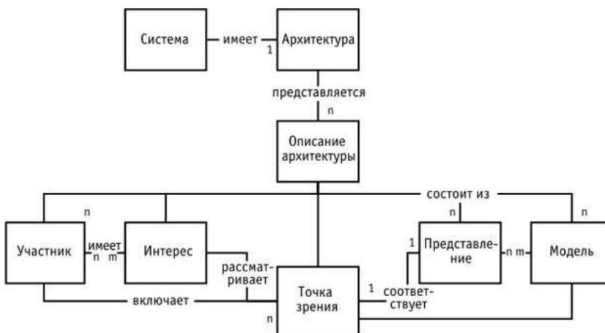
Рисунок 3 – Рамочная модель разработки архитектуры по IEEE 1471
