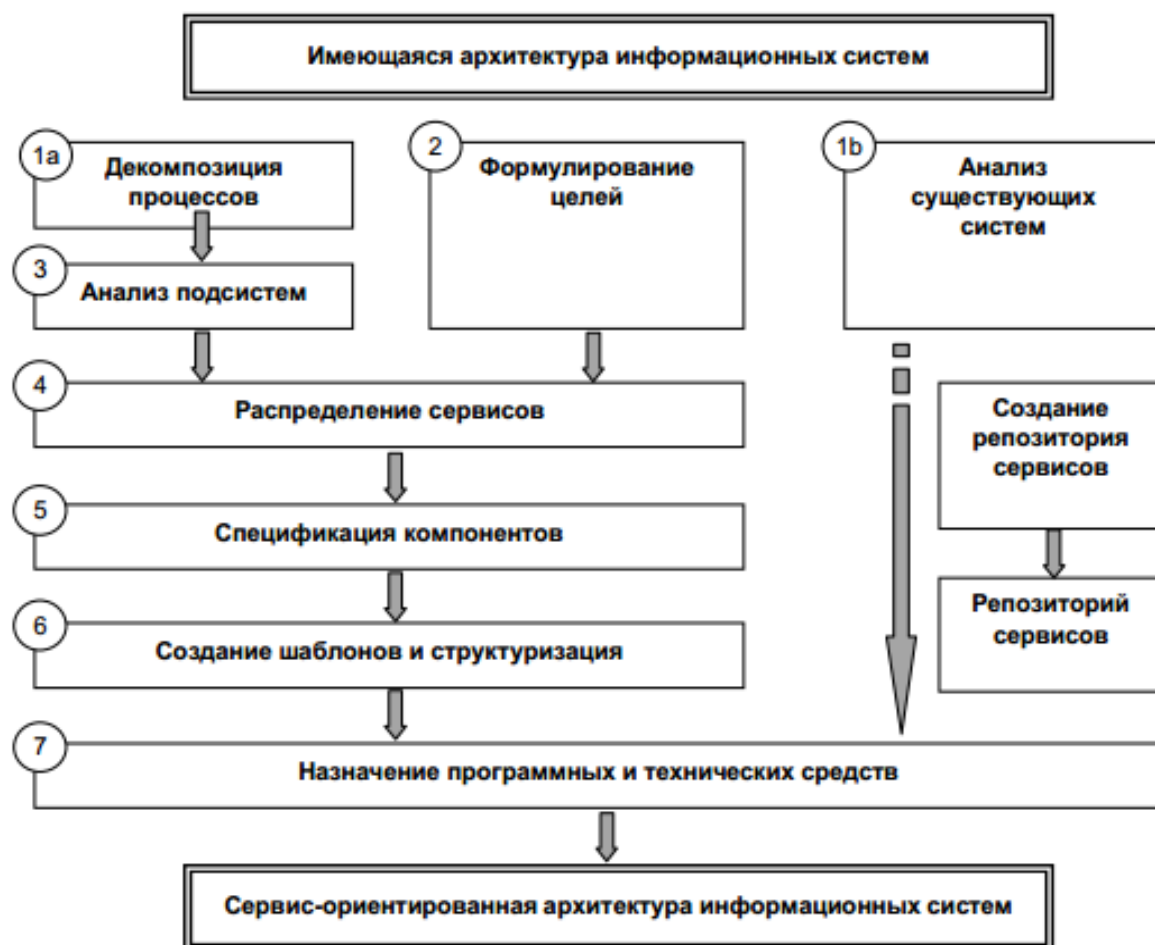
Рисунок 9 – Схема процесса преобразования имеющейся архитектуры информационной системы в сервис-ориентированную архитектуру
