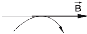
Рис. 73. К понятию силовой линии магнитного поля и вектора индукции магнитного поля \vec{B}
