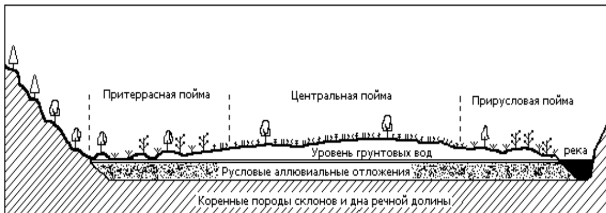
Рис. 3. Схема профиля рельефа поймы (по В.Вильямсу)
