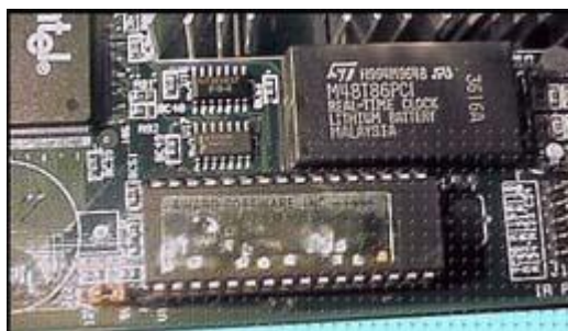
Рис. 1 - Интегральные схемы BIOS и CMOS
