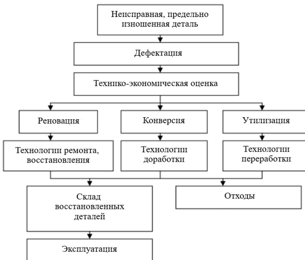
Рисунок 2 - Принципиальная схема рециклинга изношенных деталей
