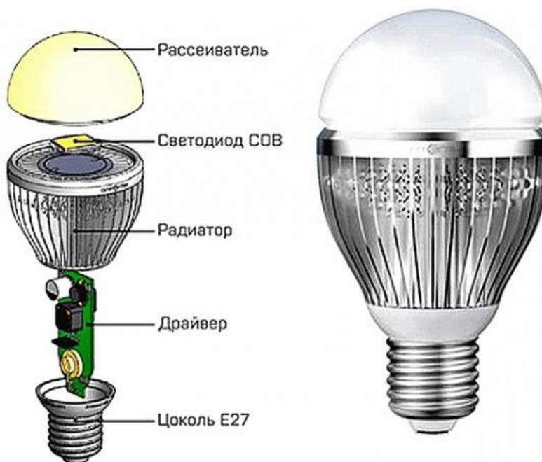
Рисунок 2- Устройство светодиодной лампы
