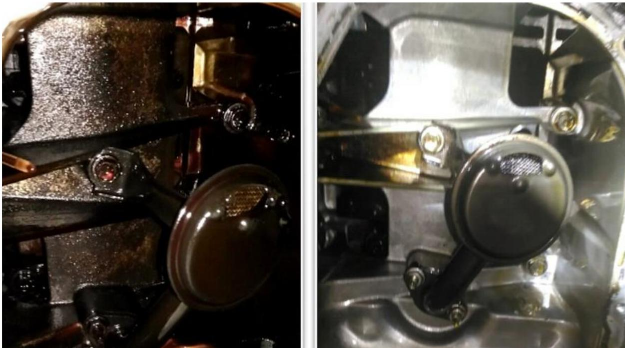
Рисунок 2 – Визуальный результат правильной промывки с помощью ДМСО
