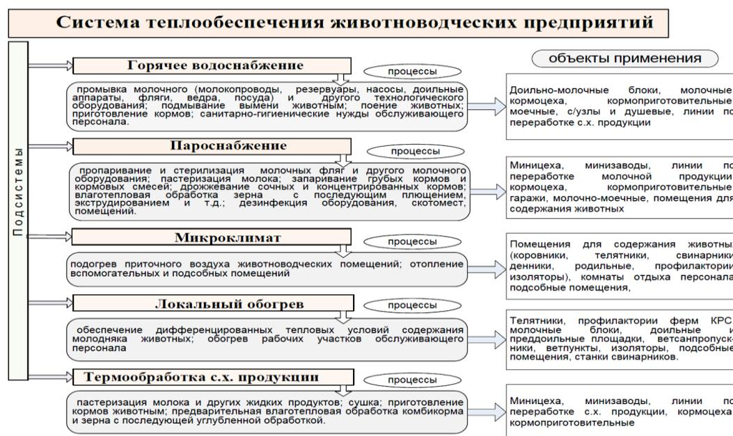
**Рисунок 1. Структура теплообеспечения животноводческих комплексов**
