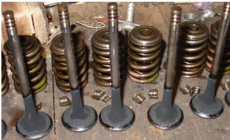
Кратко, ГРМ функционирует так, что в процессе вращения распределительного вала на клапан оказывает воздействие толкатель.
