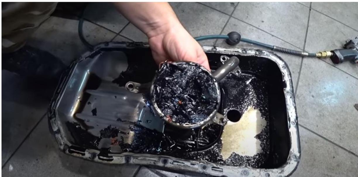
**Рисунок 1 – Последствия неудачной промывки ДВС препаратом ДМСО**
