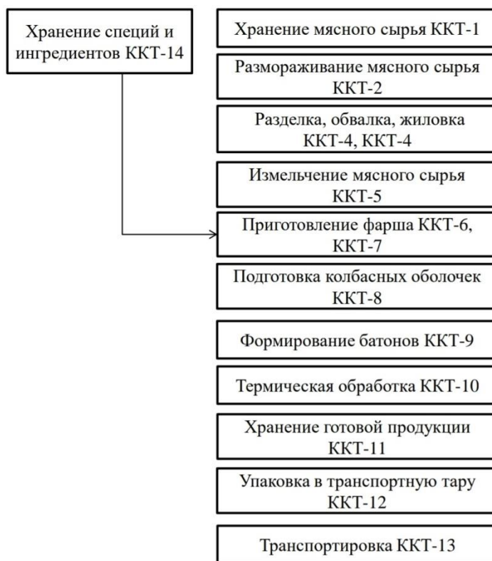
Рисунок 1 – Блок-схема производства в/к колбас
