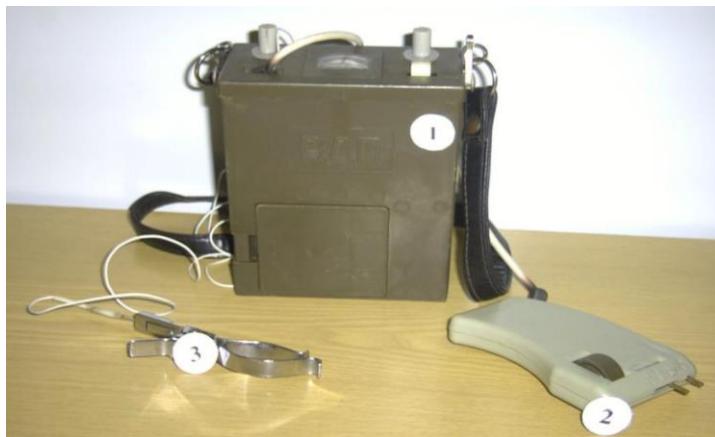
Рисунок 1- Внешний вид ветеринарно-диагностического прибора (ВДП). 1- блок регистрации и питания; 2-активный электрод; 3-пассивный электрод.
