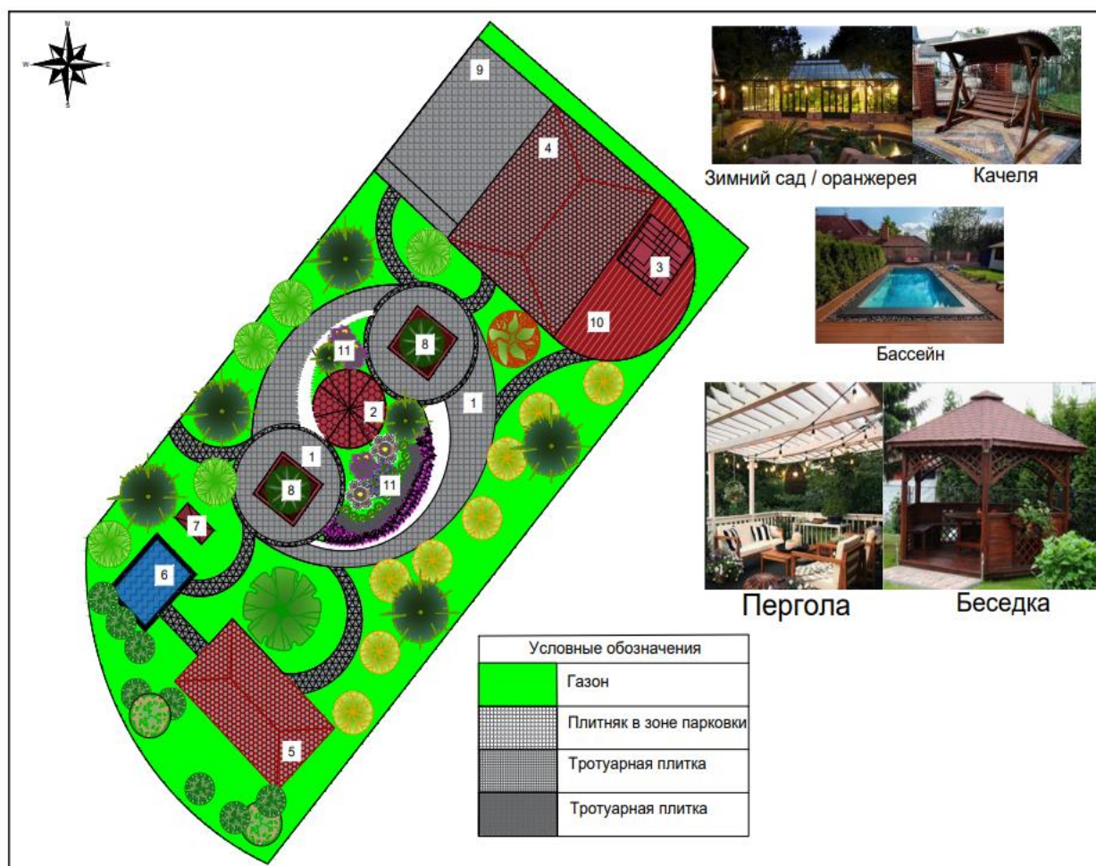
Рисунок 1 – Генеральный план: 1-дорожка, 2-беседка, 3-пергола, 4-дом, 5-зимний сад, 6-бассейн, 7-качеля садовая, 8-клумба с деревьями, 9- парковка, 10-терраса, 11-цветник
