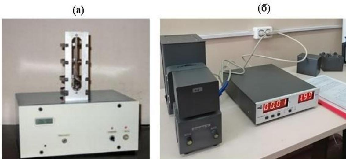
**Рисунок 1 – Установка лабораторной работы «Определения удельной теплоты кристаллизации и изменения энтропии при охлаждении олова» (а); установка лабораторной работы «Изучение внешнего фотоэффекта» (б).**
