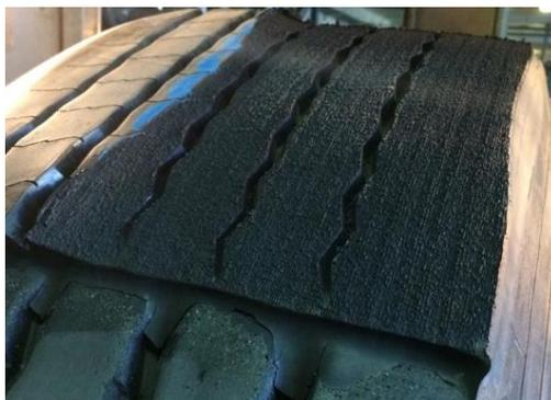
Рисунок 1 – Вид восстановленного протектора шин грузового автомобиля
