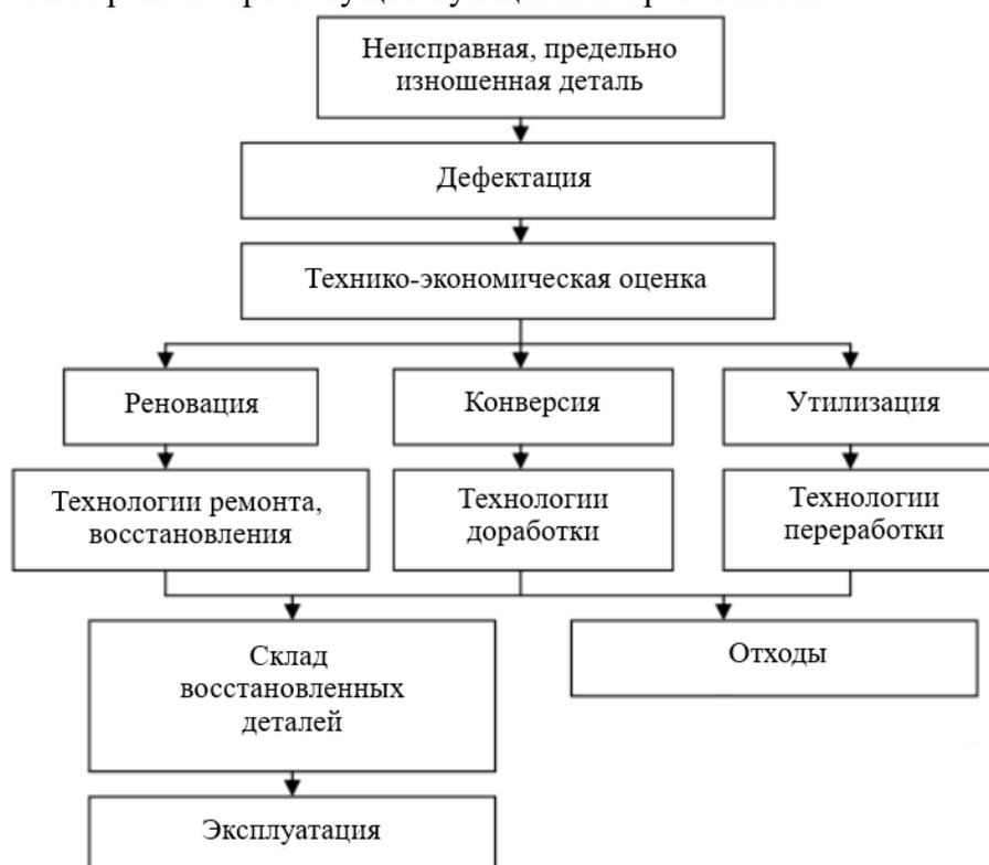
Рисунок 1 - Принципиальная схема рециклинга изношенных деталей
