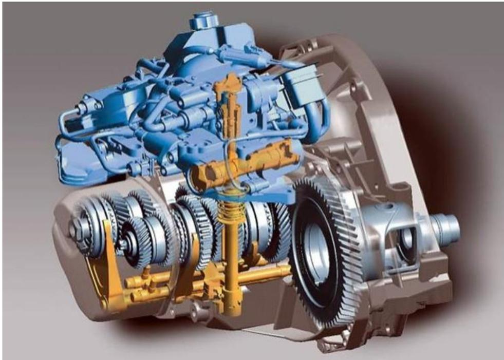
Рисунок 1 - Трансмиссия с роботизированным переключением передач
