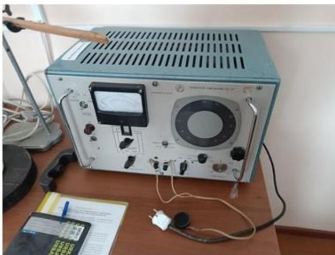
**Рисунок 1 – Звуковые генераторы: «Генератор сигналов ГЗ-18 низкочастотный» (а),
