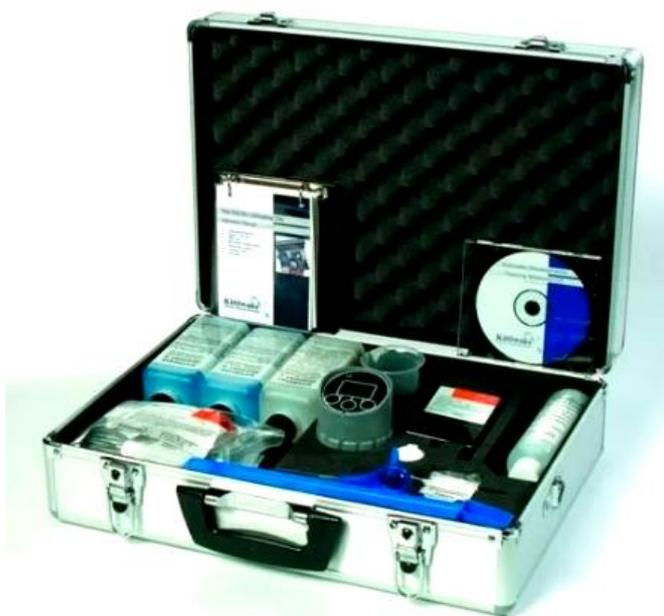
Рисунок 1 - Портативная лаборатория "Kittiwake" для анализа качества смазочных материалов и топлив
