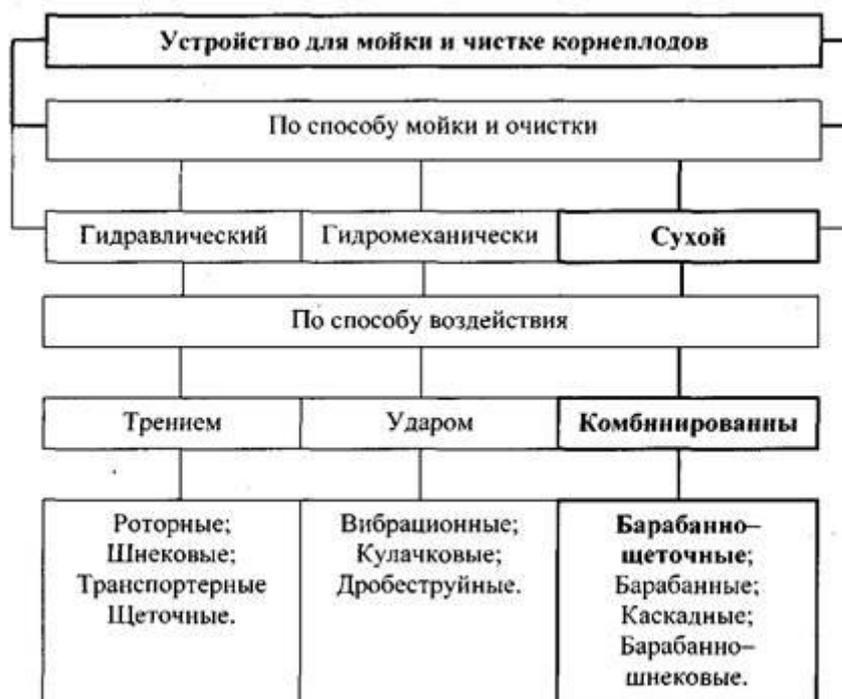
Рисунок 1 - Классификация устройств для мойки и чистки корнеплодов.
