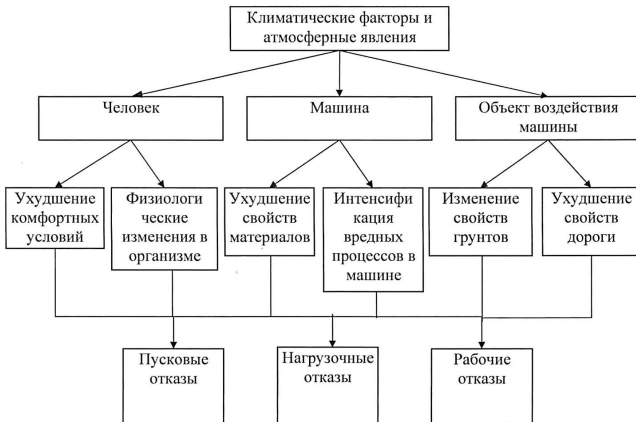
Рисунок 2 - Схема воздействия климатических факторов в системе человек- машина- объект воздействия машины [3]
