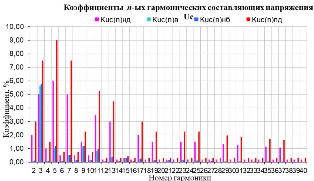
Рисунок 3- График изменения коэффициента  $n$ -ых гармонических составляющих напряжения  $U_C$
