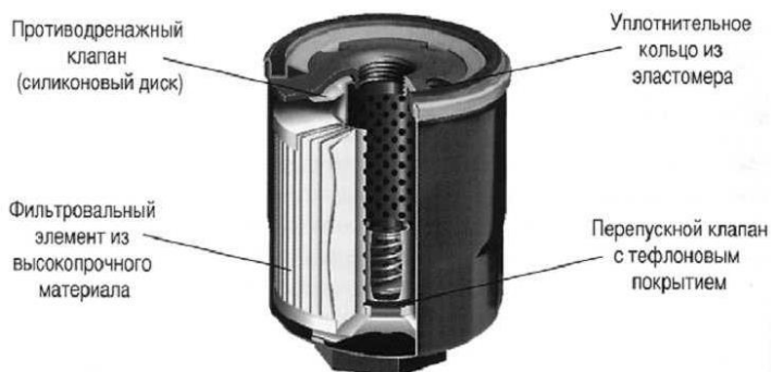
Рисунок 1 – Конструкция корпусного масляного фильтра
