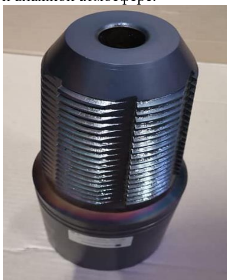
Рисунок 1. Азотирование метчика с глубиной слой около 0,1 мм, твёрдость около 30 HRC Сердцевина сталь 40X 28-32 HRC.
