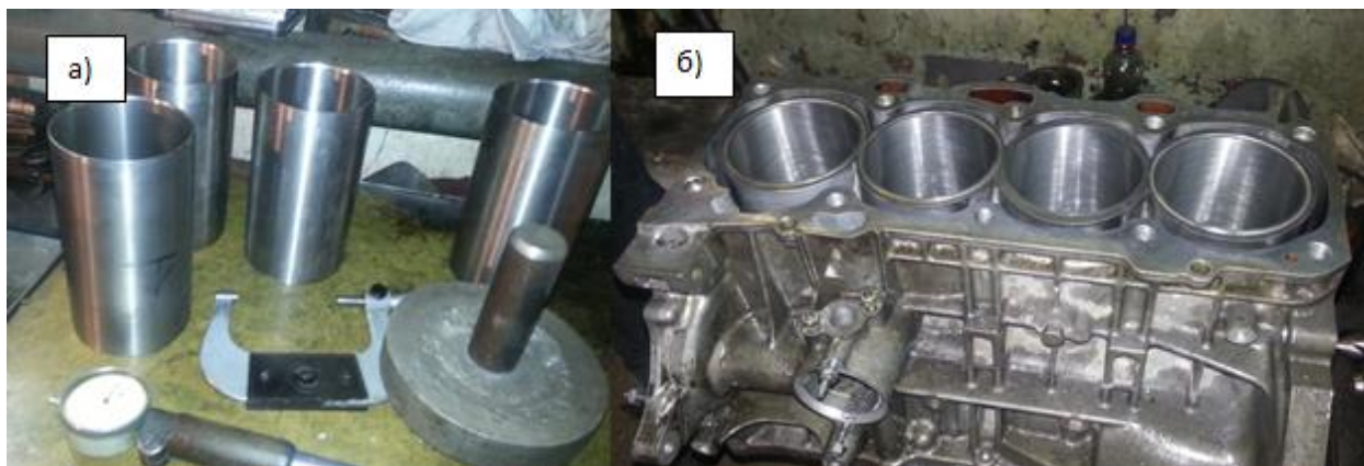
а) перед установкой; б) после нанесения хона Рисунок 2 – Гильзы блока цилиндров
