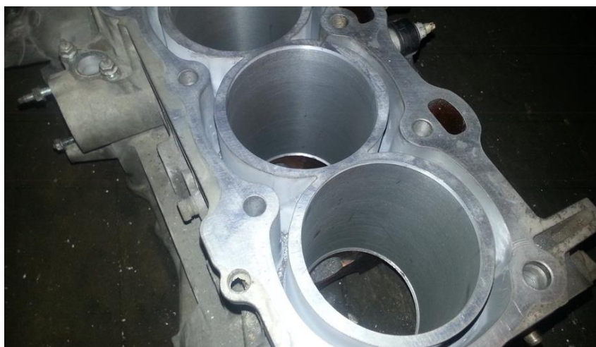
Рисунок 1 – Гильза блока цилиндров с «полкой» (на примере автомобиля Toyota Ipsum, 2003, 2AZ-FE)
