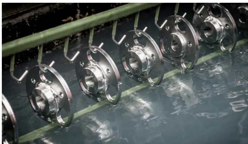
Рисунок 1 – Детали после восстановления гальваническим покрытием
