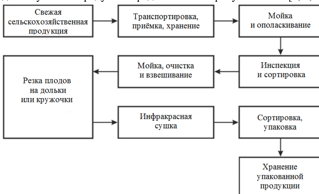
Рисунок 1 – Структурная схема технологии получения сушеных продуктов
