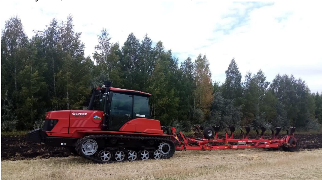
Рис. 1. Испытания пахотного агрегата (трактор “Фермер РБ -2103” + UNLU 7)
