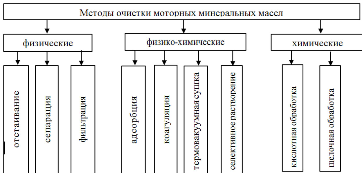
Рисунок 1 – Методы очистки моторных минеральных масел
