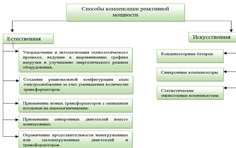
Рисунок 3 – Способы компенсации реактивной мощности
