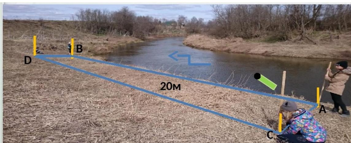
Рис.2 Определение скорости течения реки
