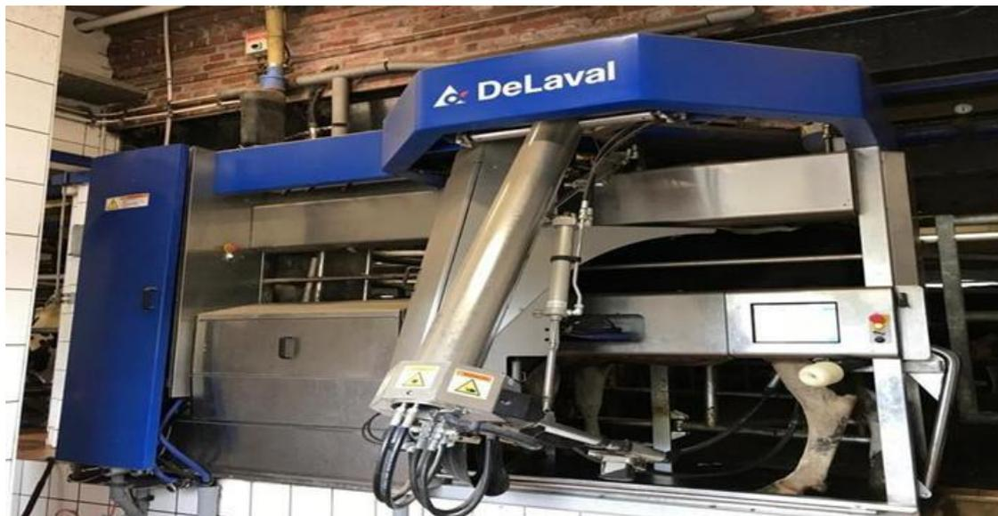
Рисунок – Доильный робот VMSDeLaval
