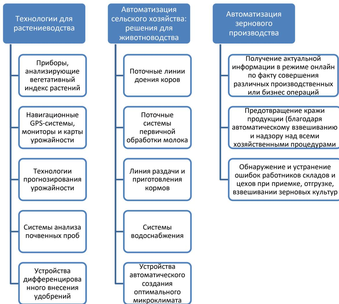
Рисунок - Технологии автоматизации производственных сельскохозяйственных процессов
