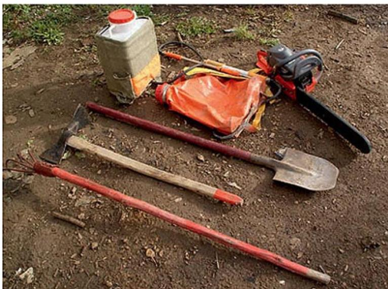
Рисунок 1 – Ручные средства тушения лесных низовых и степных пожаров (слева направо): мотыга, топор-кирка, лопата, огнетушитель ранцевый, бензопила
