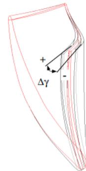
Рис 10. Изменение геометрии радиальной лопасти по кривизне
