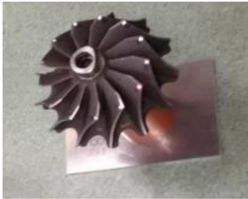
Рис 7. Турбинное колесо турбокомпрессора с дополнительными массами на лопатках
