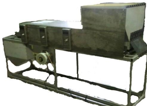
**Рисунок 8 – СВЧ-модуль для предпосевной обработки семян хвойных пород деревьев**
