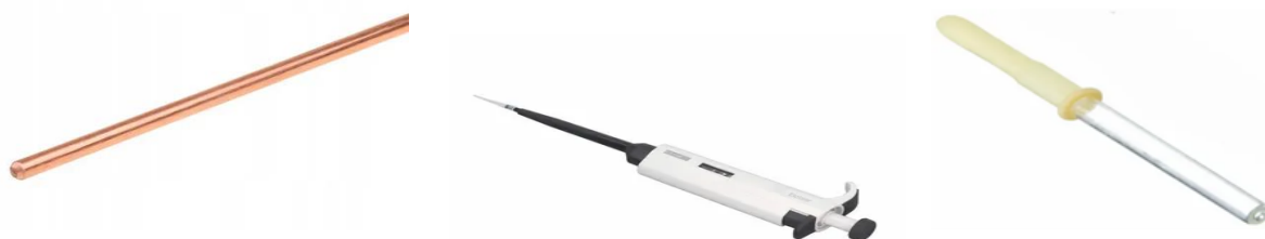
а б в Рисунок – Устройства для нанесения капли масла на фильтровальную бумагу: а – медный стержень; б – поршневая микропипетка; в – офтальмологическая пипетка
