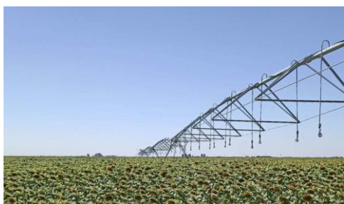
Рисунок 2 – Фронтальная дождевальная машина ZDM 300 м (линейная)
