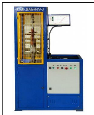
Рисунок 3 – Стенд для испытания амортизаторов ИТМ010201
