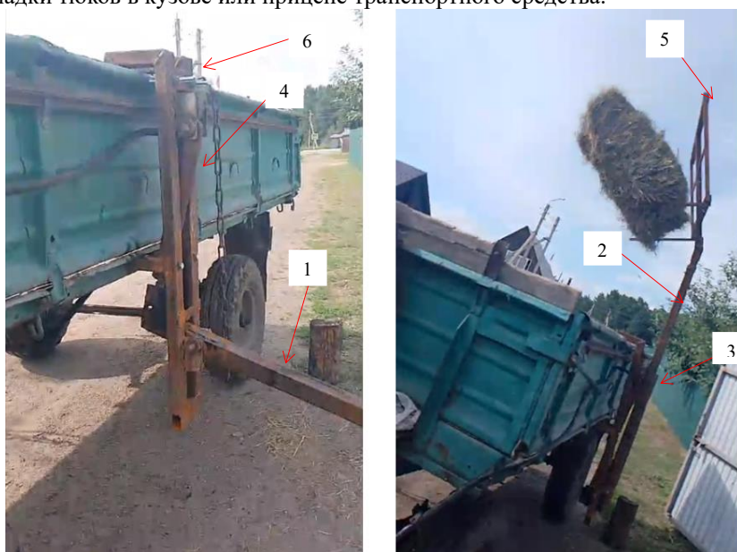
Рисунок 1 – Гидравлическое устройство для поднятия и укладки тюков: 1 – основание гидравлического устройства, 2 – выдвижной механизм, 3 – соединительное устройство «винт-гайка», 4 – крепление устройства к борту, 5 – соединительные элементы «косынка сварочная», 6 – гидравлический цилиндр.
