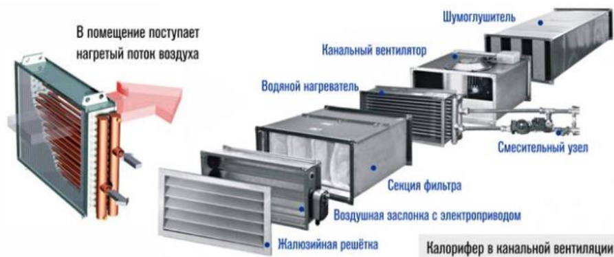
Рисунок 3 – Калорифер в канальной вентиляции [4]
