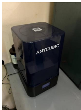
Рисунок 3 – Фотополимерный 3D- принтер Anycubic Photon Mono 2
