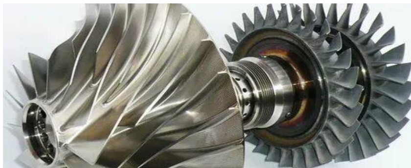
Рисунок 1 – Общий вид осевых и радиальных рабочих колес ГТД и ГТУ
