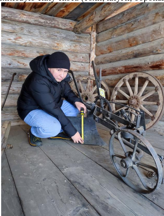
Рисунок 1 – Определение геометрических параметров корпуса плуга
