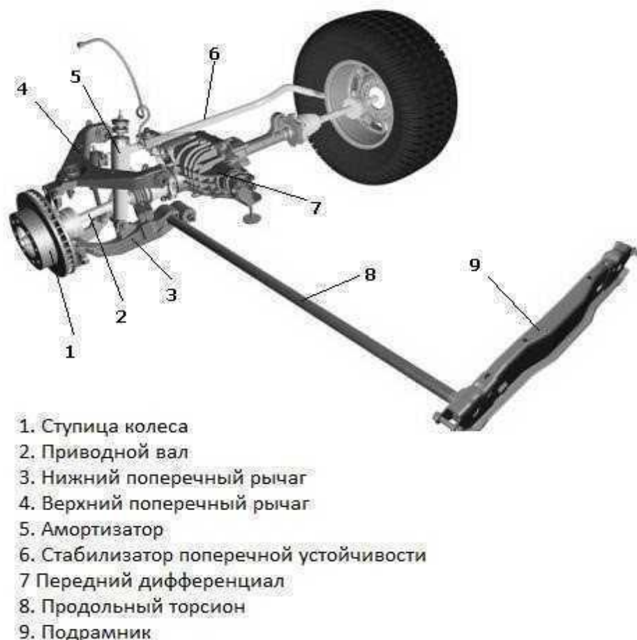
Рисунок 1 – Схема устройства торсионной подвески
