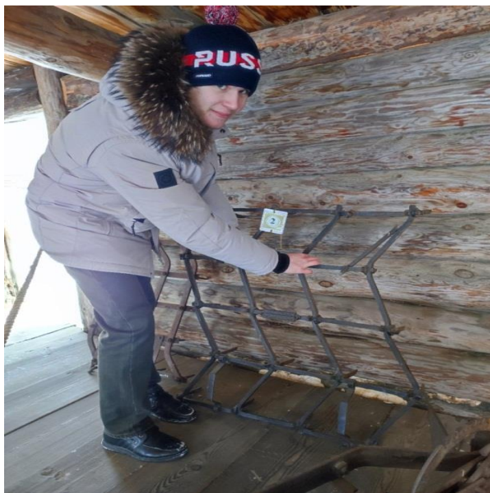
Рисунок 2 – Определение геометрических параметров зубовой бороны
