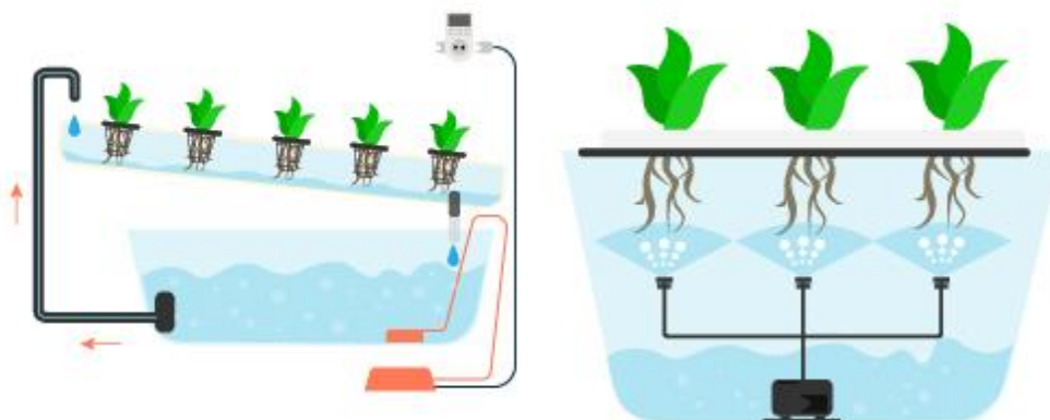
1 – системы с проточной водой (NFT) 2 – аэропонная система
