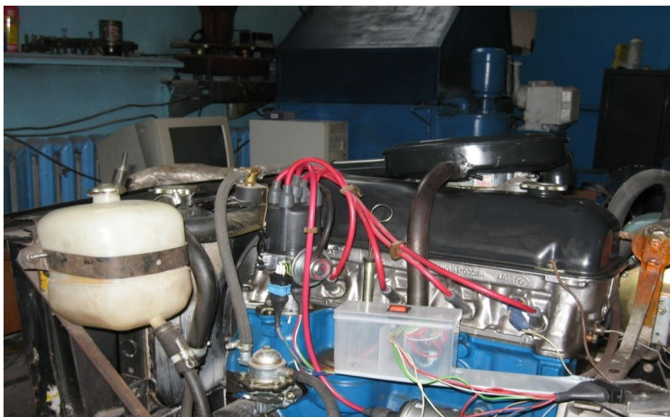
Рисунок 1 – Экспериментальная установка для проверки работоспособности датчик – распределителя бензиновых двигателей, работающих на газообразных видах топлива
