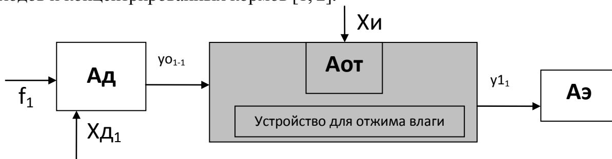
Рисунок 1 – Структурная схема функционирования линии экструдирования рыбных отходов: Ад – устройства для дозирования; Аот – устройство отжима влаги; Аэ – устройство экструдирования; f_1 – обобщенные статистические показатели, характеризующие состав кормов, поступающих на отжим, их физико-механические свойства; X_{д1} – обобщенные значения внутренних факторов дозирующих устройств кормовых компонентов; X_{и} – обобщенные значения внутренних факторов отжимающих устройств кормовых компонентов; y_{01-1} – масса кормовой порции компонента, поступающей на отжим; y_{11} – масса смеси (производительность отжимающего устройства); обобщенные показатели, характеризующий энергоёмкость Y_{э} , материалоемкость и надёжность Y_{мн} системы средств механизации приготовления кормов, в структурную схему условно не введены.
