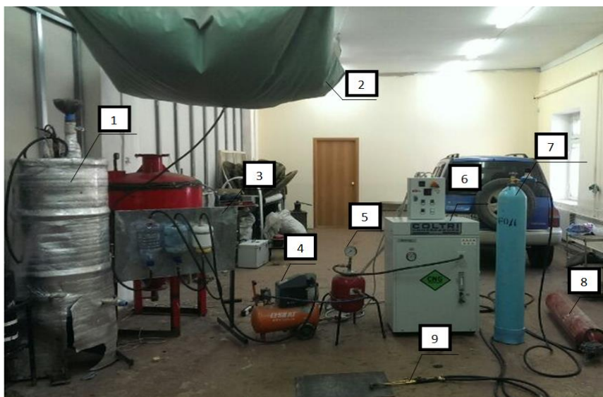
Рисунок 1- Общий вид лабораторной биогазовой заправочной станции для применения газовой резки: 1-биогазовый реактор; 2-газгольдер; 3-биогазовый фильтр; 4-компрессор низкого давления КПП-230-24; 5- Накопительный ресивер; 6 - компрессор высокого давления МСН-10; 7 – Кислородный баллон; 8 – Метановый баллон; 9 – Метановый резак.
