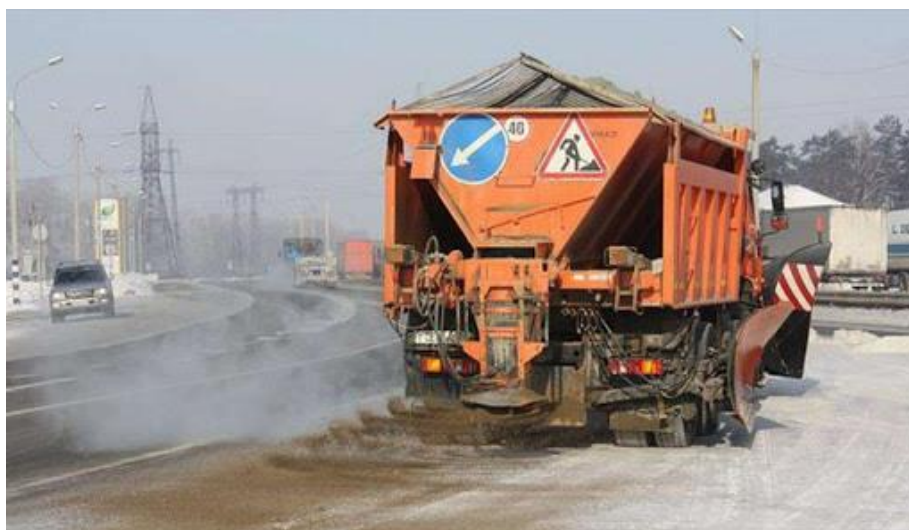
Рисунок 2 – Фрикционный метод борьбы с зимней скользкостью: процесс рассыпки абразивного материала (песка) на поверхность дороги автомобилем-разбрасывателем МД-43253
