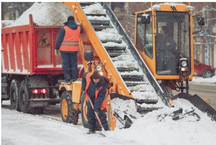
Рисунок 1 – Механический метод борьбы с зимней скользкостью: процесс удаления снега с полотна дороги снегоочистителем АМКОДОР 37 с одновременной его погрузкой в кузов автомобиля-самосвала КамАЗ 65115
