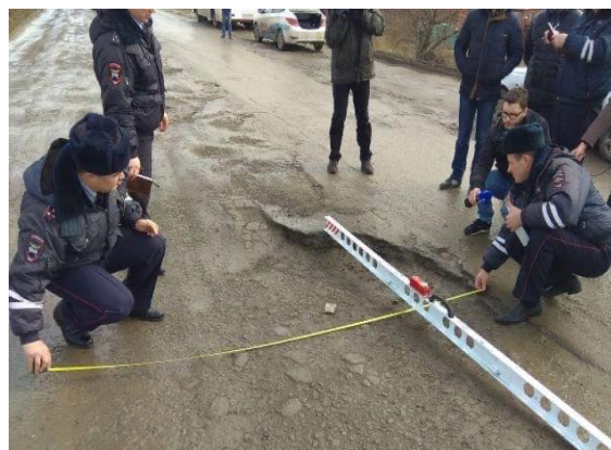
Рисунок 4 – Измерение геометрических размеров сетки трещин, шелушения, выкрашивания и выпотевания (схема измерения по ГОСТ 32825)
