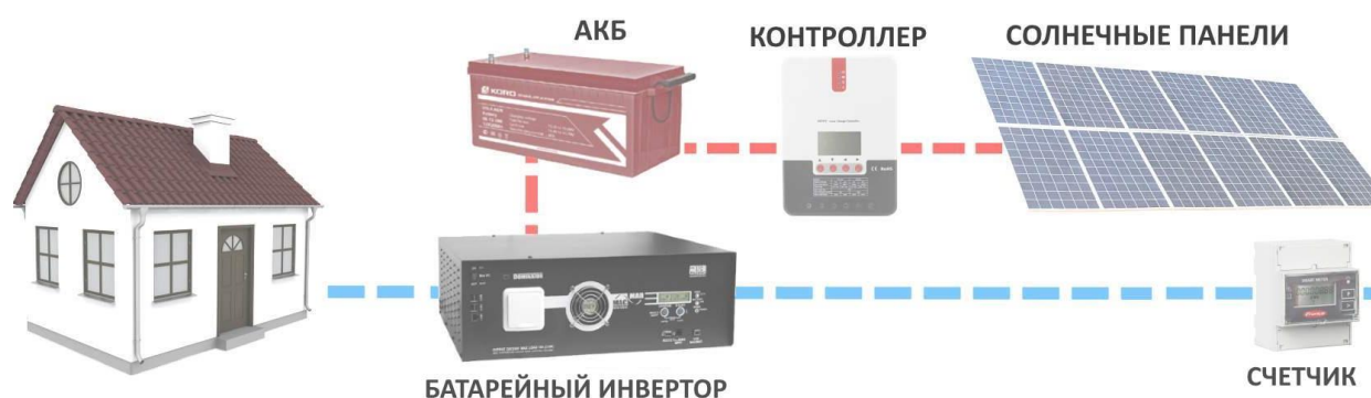
Рисунок 1 – Гибридная солнечная электростанция
