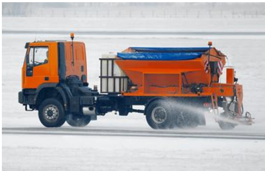
Рисунок 4 – Химический метод борьбы с зимней скользкостью: процесс нанесения реагента на поверхность дороги агрегатом (МДК-5340) на базе автомобиля МАЗ
