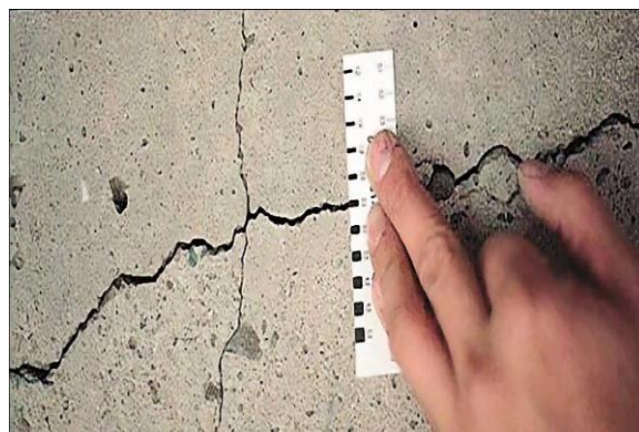
а - длина повреждения; б – пример измерения ширины раскрытия трещины линейкой-шаблоном
