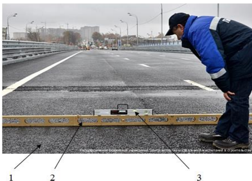
Рисунок 1 – Иллюстрация метода измерения ровности покрытия на основе применения трехметровой рейки: 1 – покрытие; 2 – рейка; 3 – встроенный уровень
