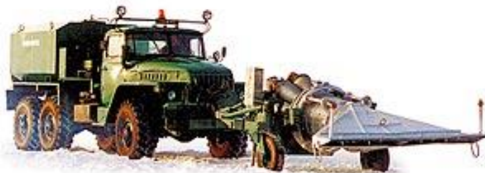
Рисунок 3 – Тепловой метод борьбы с зимней скользкостью: процесс теплового воздействия на обледеневшую поверхность дороги агрегатом ТГМ-3А-01 в составе автомобиля Урал-43203-1012-10
