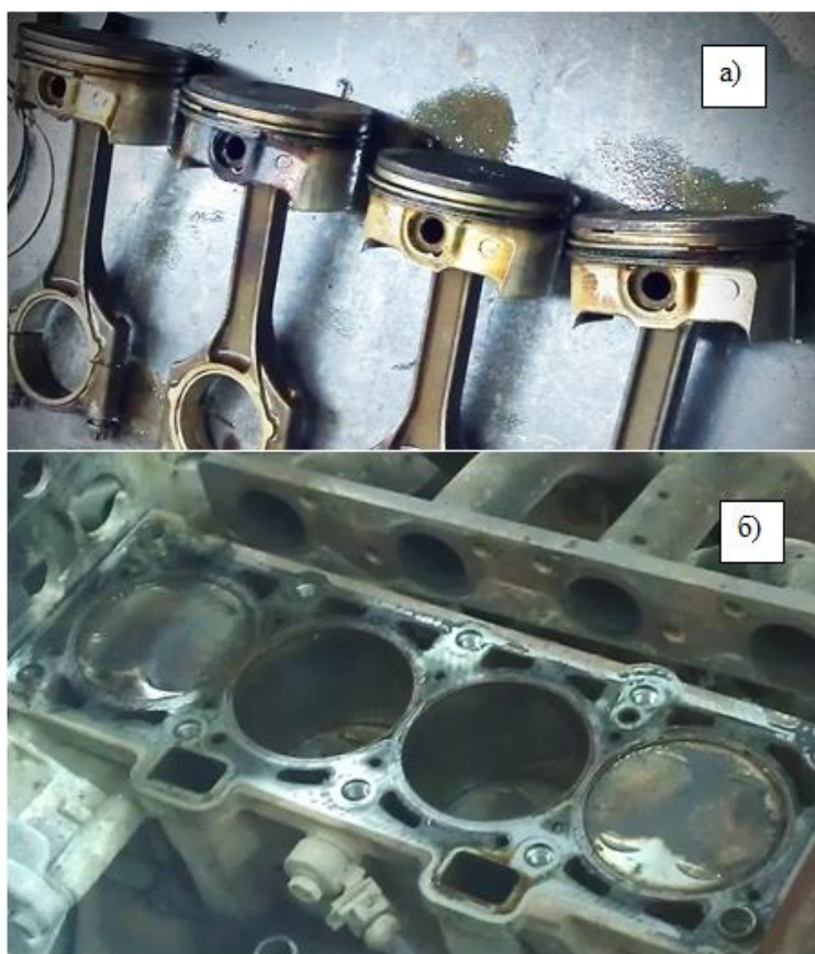
Рисунок 2 – Поршневая группа, устанавливаемая заводом-производителем а – общий вид, б – проточки на днище поршня
