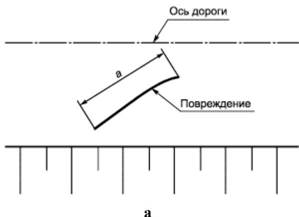
а - длина повреждения; б – пример измерения ширины раскрытия трещины линейкой-шаблоном
