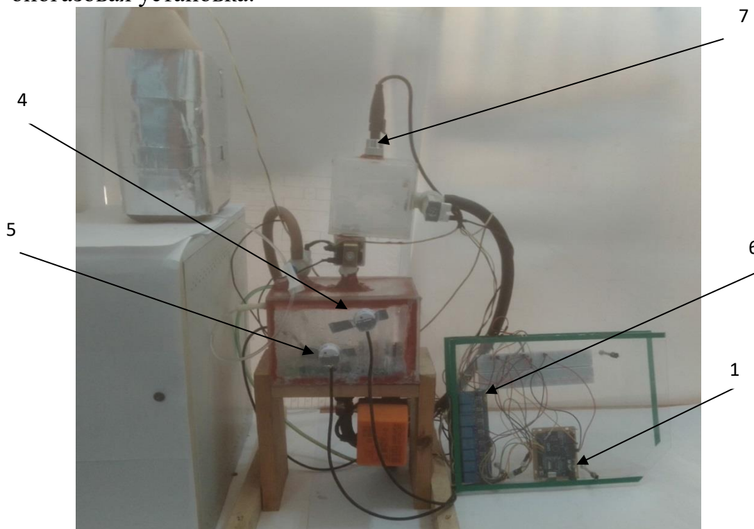
Рисунок 3 - Автоматизированная макетная биогазовая установка
