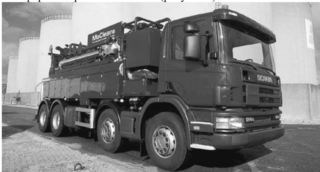
Рисунок 6 – Установка для мойки резервуаров с нефтепродуктами
