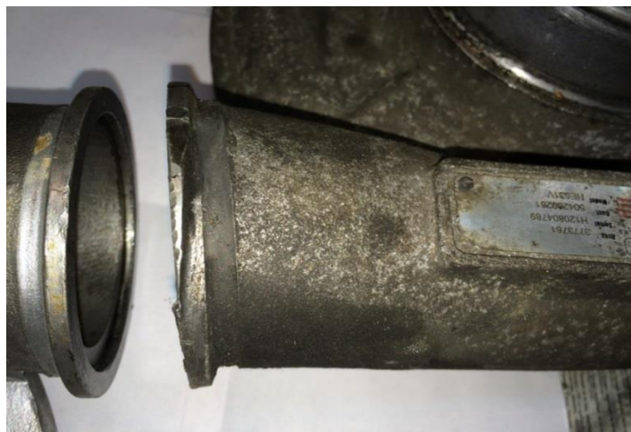
Рисунок 5 – Износ корпуса компрессора (воздушной улитки) в месте крепления на интеркулер
