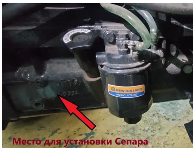
Рисунок 4 – Предварительное местоположение предлагаемого дополнительного топливного фильтра (SEPAR SWK-2000/5)
