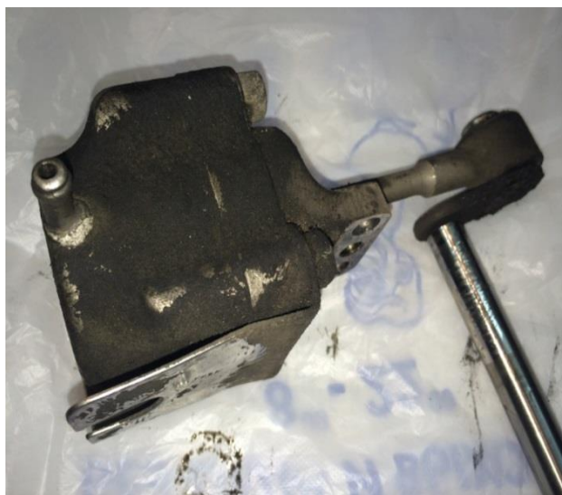
Рисунок 4 - износ штока управления геометрией
