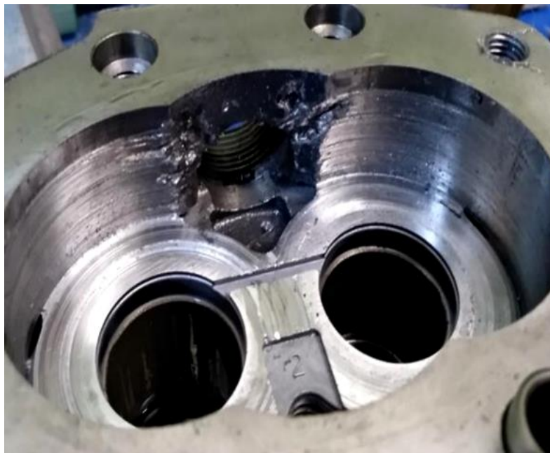
Рисунок 2 – Разрушение стенок камеры нагнетания насоса
