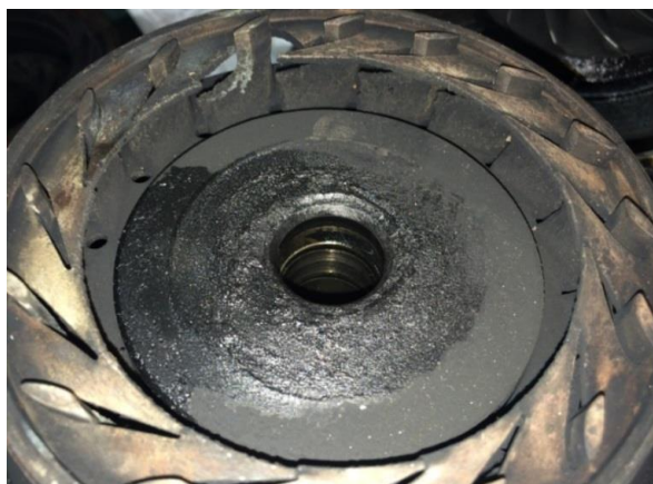
Рисунок 2 - Частичный или полный отрыв кольца геометрии турбины вследствие износа
