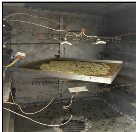
Рисунок 3 - Расположение керамических нагревателей в сушильном шкафу
